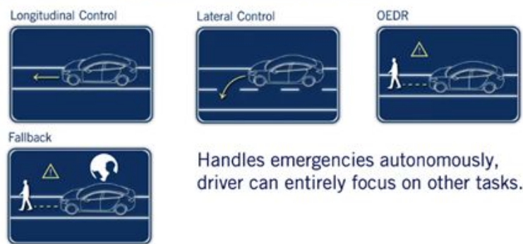
Figure 9: Level 4 AV (Image Source: [11])
