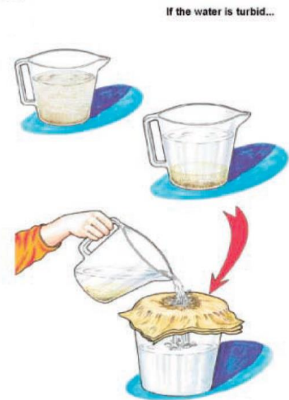
Fig. 2.6 Simple turbidity test (Meierhofer and Wegelin, 2002)
