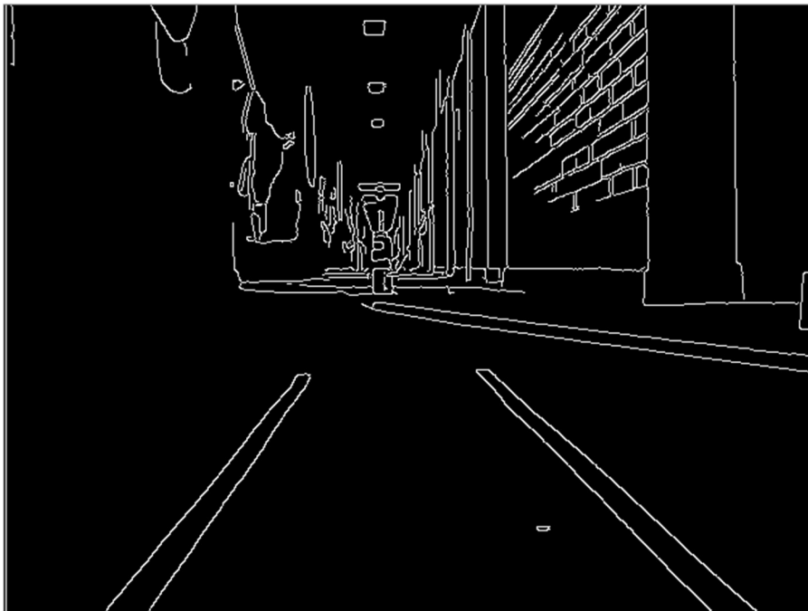
Fig. 5.2 Edge detected Frame
