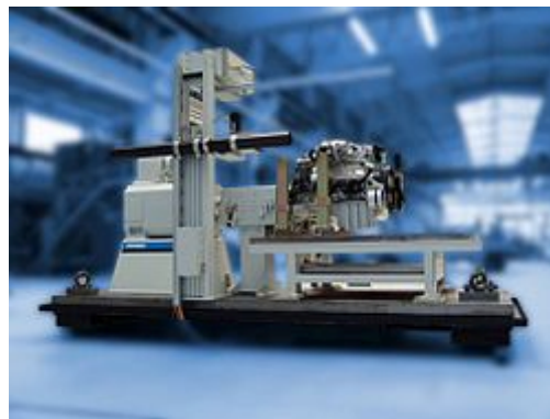
Fig: 2.d-HORIBA engine test stand type TITAN
